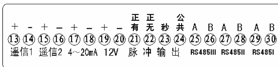
图 5 (b) 集中器辅助接线端子示意图 (带交采)
