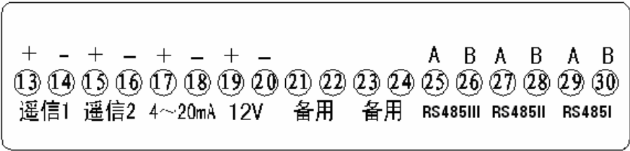
图 4（b） 集中器辅助接线端子示意图（不带交采）
